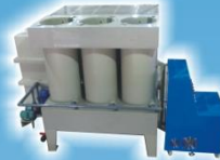
微蝕液回收銅設備
