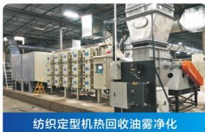
纺织定型机热回收油雾净化
