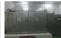
大型步入式複合鹽霧試驗箱(溫度/濕度/腐蝕)
